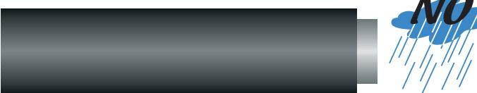
Не устанавливайте изоляцию в дождь, при повышенной влажности - это может повредить адгезионным свойствам.
