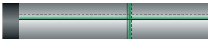
Всегда размещайте нахлест таким образом, чтобы предотвратить затекание воды в шов («против воды»).
