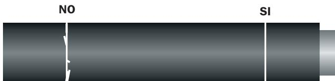
Всегда используйте **острые лезвия** для раскройки материала для предотвращения сминания и разрывов изоляции.
