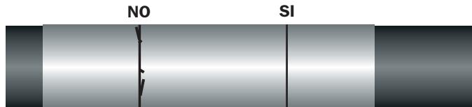
Всегда используйте **ножи с острыми лезвиями** для раскройки и резки материала для предотвращения сминания и разрывов покрытия.
